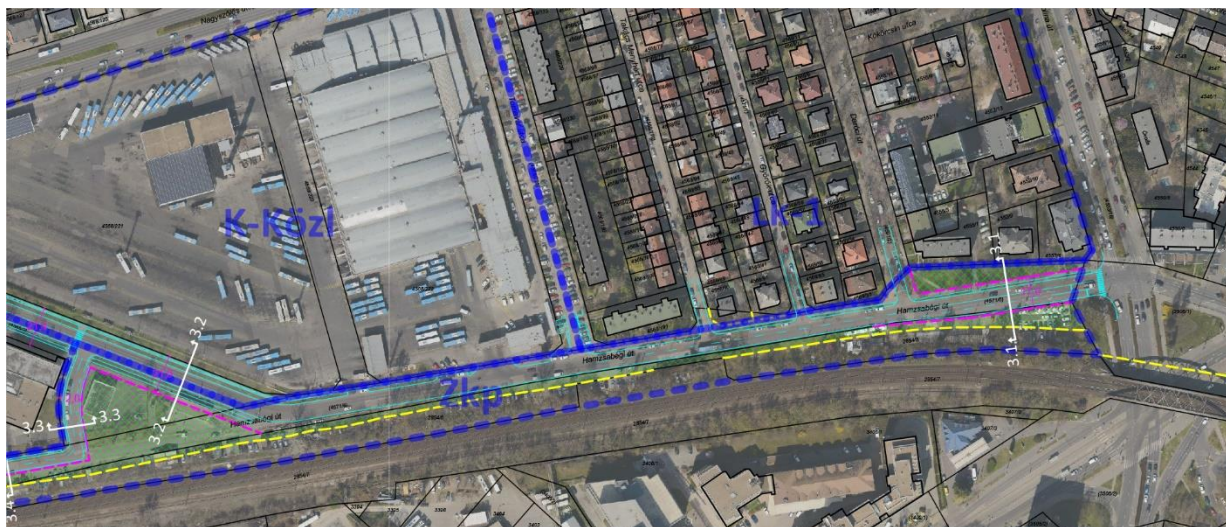
7.1. ábra: A kialakult állapot légifotón, a Zkp területfelhasználási egység, valamint a meglévő és a tervezett szabályozási határvonalak bemutatása (HR-02 melléklet – Helyszínrajz-02 részlete) a Bartók Béla út és az Ajnácskő utcai csomópont közötti szakaszon
